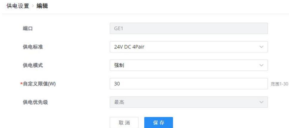
图 69 供电设置 - 编辑端口
